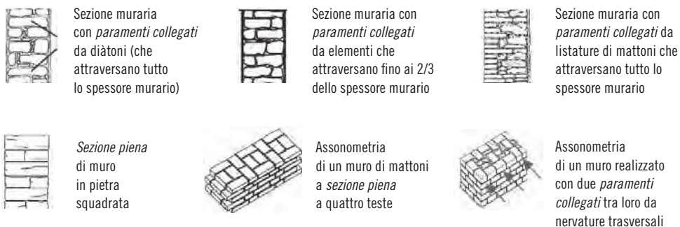
Fig. 3.1 – Pc: sezione a paramenti ben collegati o ad unico paramento (sezione piena)
