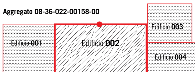
Fig. 2.6 – Esempio di rappresentazione di aggregato con evidenziazione dell'edificio oggetto di sopralluogo (Edificio 002).
